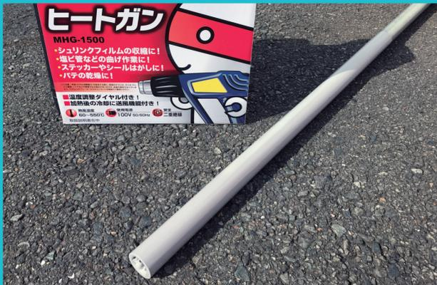
ヒートガン (ホットガン) ドライヤーのような形状をしており高温の風を送ることができる。その他の用途として塩ビ管を曲げたりも出来るため 1 台あると便利。
