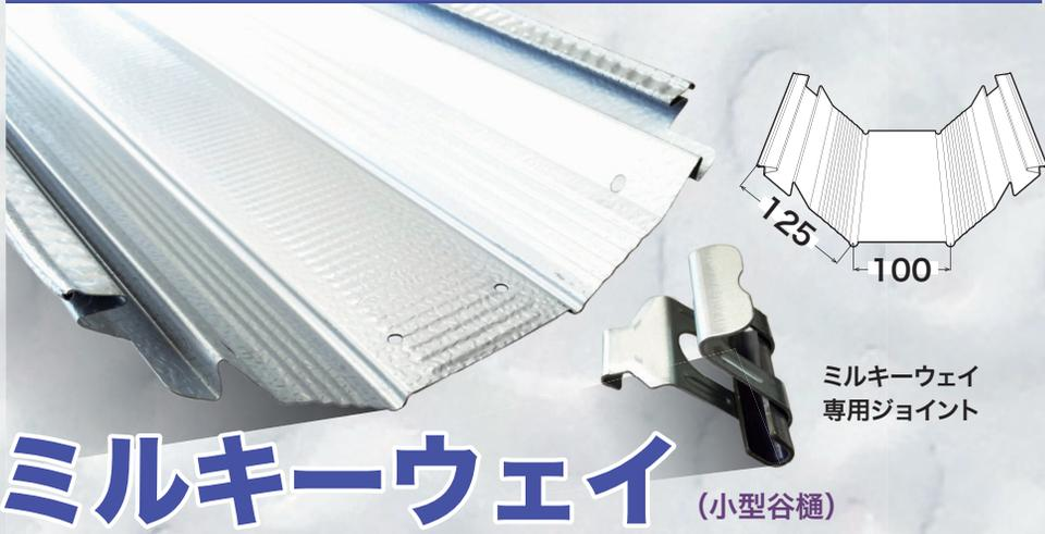
ハウス連棟用谷樋のアマノガワに兄弟ができました。その名もミルキーウェイ。材料はカラーとアルミの2種類をご用意。表面に凹凸加工を施す事によって同材料、同形状の物に対して強度が約 20%向上しております。さらに、アルミ材の表面には樹脂コーティングを施しており、フィルム焼けの軽減や腐食防止、熱伝導率低下が期待できます。
