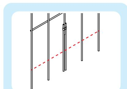
補修したパイプが他アーチと並列に並ぶので、クロス金具などが取付けしやすい。
