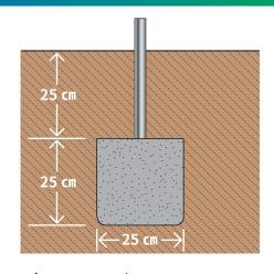
25 cm四方のあしがためを 25 cm 埋め戻した試験体の引抜き荷重は
