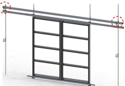
また、追加でプレートを2個柱に取り付けると、カンヌキ材の置き場を確保できます。
