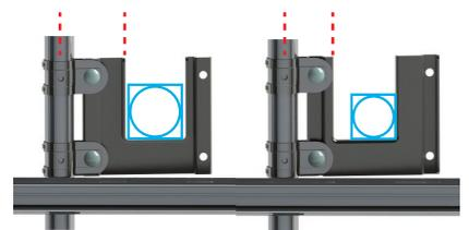
プレートの逆穴を使うと妻柱とカンヌキ材の間隔が変わります。間隔が広い方が50角(φ48.6)用、狭い方が32角(φ31.8)用です。
