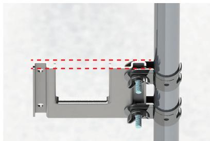
曲げ加工により、厚みを持たせていますので、ユニバーサルが最後まで締まらない設計です。
