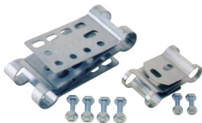
19.1、22.2、25.4、31.8のパイプ同士を好きな組み合わせで並列に結合し、アーチパイプの強度を上げる金具。上からの力に対する強度アップにより雪にも強い。調整可能な形状なので既設のハウスに取付けることができる。
